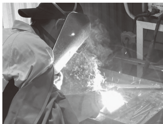
アーク溶接作業（溶接基本実習）
