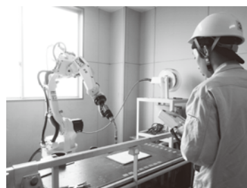
溶接ロボット
